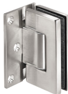
Samozavírací regulovaný pružinový závěs s aretací \pm 90^\circ s bočním kotvením (sklo - zeď)
